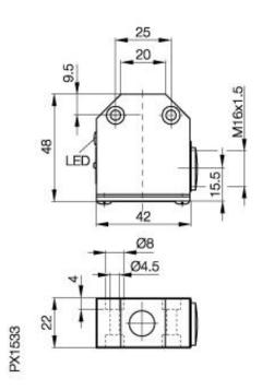
Induktiver Näherungsschalter BES 516-341-H2-Y 22 x 42 x 48 Öffner Sn=5mm bündig einbaubar
